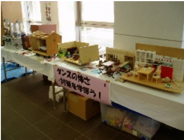
小さな模型を固定したのと、してないの違いを見る。 台の下には木製の玉が敷かれており手で揺する
